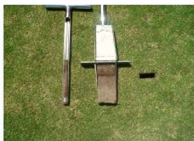
L'échantillon est extrait du sol pour être inspecté, puis la lame de coupe est simplement ouverte à l'aide d'une charnière spécialement conçue. L'échantillon de la totalité du profil racinaire peut être consulté instantanément.
