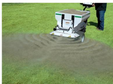
La Dakota 310 est une sableuse à épandage centrifuge double disques pour conducteur marchant. Le profil d'épandage, jusqu'à 6 mètres de large, est réglable en continu par commande au guidon. Sa construction robuste et compacte ainsi que sa simplicité d'utilisation en font l'outil idéal pour répandre du sable, des engrais ou du remplissage (sable et caoutchouc sur terrains synthétiques) lorsque l'accès est limité ou les terrains de qualité.
