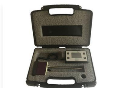
L'humidimètre Field Scout TDR 150 mesure l'humidité, la température et la conductivité électrique du sol. Il transfère les données en Bluetooth. La conductivité électrique (CE) est une fonction de l'humidité et du sel dans le sol. L'humidité mesurée est le pourcentage en volume d'eau dans le sol (%VWC). La température est celle au bout des broches.
