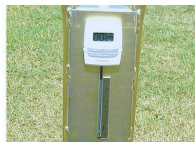
L'infiltromètre détermine le taux d'infiltration d'eau sur toutes les zones en moins de 15 minutes. Cet instrument détermine la vitesse de percolation en mm/h qui illustre le temps que va mettre l'eau pour rentrer dans le sol.
