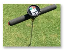
Le nouveau testeur numérique de compaction des sols est une version numérique du pénétromètre analogique. Il utilise un capteur de force électronique qui élimine le besoin de changer la taille de la pointe pour les différents types de sol. L'écran LCD indique en PSI ou kPa le niveau de compaction avec un code couleur vert/jaune/rouge. Il est robuste et répond à la norme de compactage des sols ASABE S313.3.
