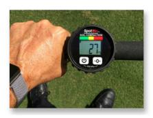
En enfonçant le testeur numérique de compaction dans le sol avec une pression régulière vers le bas et en regardant l'affichage numérique, vous pouvez identifier les profondeurs de compaction critiques jusqu'à une profondeur de 24 pouces (60 cm). L'appareil indique également la valeur maximale ou "pic" de pression après chaque lecture.
