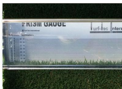
Le prisme Hauteur de Coupe est fait de verre massif et d'acier inoxydable. Il est conçu pour mesurer la hauteur réelle de coupe de vos différentes surfaces. En plaçant le prisme directement sur le terrain et en regardant à travers l'instrument, il est possible de lire la hauteur réelle et la qualité de coupe ainsi que l'uniformité de la surface engazonnée.
