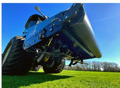
Le Shockwave d'Imants est un décompacteur linéaire à lames conçu pour revitaliser les surfaces à fort taux d'utilisation en diminuant la compaction des sols, en améliorant l'aération et en drainant les eaux de surface. Le tout sans impacter la surface de jeu
