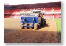
Le Speedresser 18 est un saleur en nappe gros débit conçu pour tous les matériaux de top-dressing. Les pneus basse pression minimisent le risque de marquage et de compaction. Le Speedresser 18 requiert un tracteur d'au moins 30cv. Il est entrainé hydrauliquement à partir du tracteur via un agitateur et deux rouleaux jumelés. Il a une capacité d'épandage de 2mm à 75mm de matériau en un seul passage. Idéal pour les terrains de sports et les golfs.
