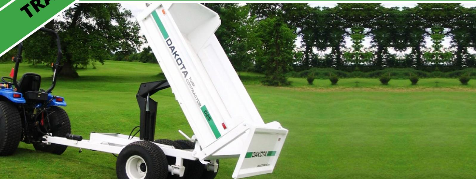
Ces remorques dotées d'un puissant vérin hydraulique peuvent soulever jusqu'à 5000 kg (capacité de la benne). Le hayon, le vérin et le châssis sont supportés par 4 pneus Ultra Trac montés sur essieux oscillants indépendants pour une meilleure répartition du poids et éviter les traces sur le gazon. L'angle de déchargement est de 65°, les ridelles sont amovibles. Les remorques Dakota sont facilement manoeuvrables, tous les réglages sont contrôlés depuis le poste de conduite.
