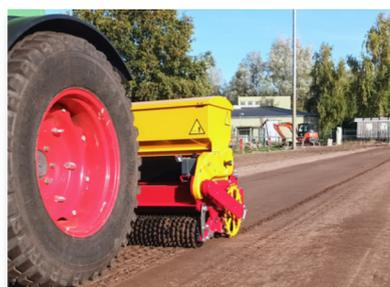
Le semoir Vredo Stitch Compact est un semoir à picots innovant équipé d'un rouleau « Stitch». Il est doté de dents fines et tranchantes au lieu des dents coniques couramment utilisées. Les incisions rectangulaires (1600/m<sup>2</sup>) enferment la graine qui est déposée d'une très faible hauteur.
