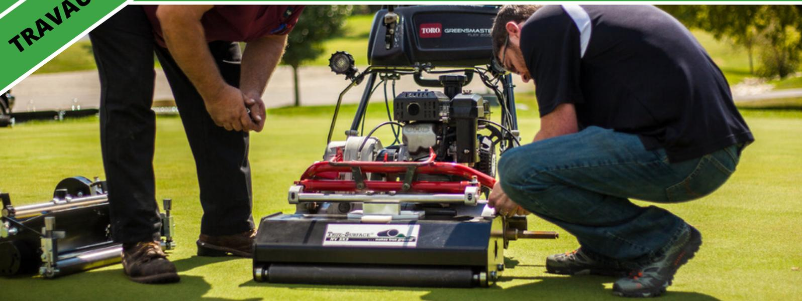
**La True-Surface® TREKKER NV 3x3™** est un rouleau pour green non-vibrant qui utilise un système novateur de Tri-Rolling pour lisser les greens sans les vibrer.
