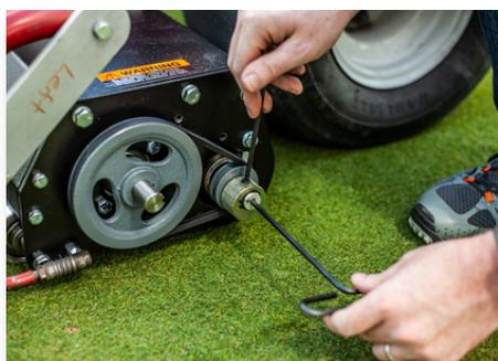
Les rouleaux vibrants True-Surface® Vibe V™ dont les seuls a proposer une intensité de vibration réglable et des isolateurs en caoutchouc pour guider la vibration vers vos greens et non vers les machines et les opérateurs. Grâce à la fonction Select-A-Vibe™, vous pouvez sélectionner le niveau de vibration que vous souhaitez - choisissez parmi les réglages 1 à 5. Aucun autre rouleau du marché ne vous permet de choisir votre niveau d'énergie.
