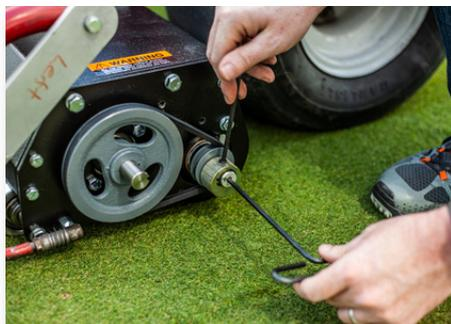
Les rouleaux vibrants True-Surface® Vibe V™ dont les seuls a proposer une intensité de vibration réglable et des isolateurs en caoutchouc pour guider la vibration vers vos greens et non vers les machines et les opérateurs. Grâce à la fonction Select-A-Vibe™, vous pouvez sélectionner le niveau de vibration que vous souhaitez - choisissez parmi les réglages 1 à 5. Aucun autre rouleau du marché ne vous permet de choisir votre niveau d'énergie.
